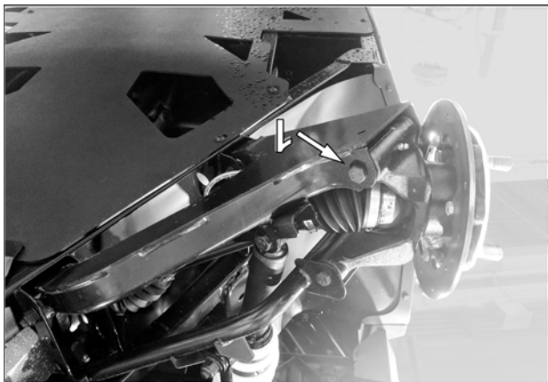
5. Retirer le boulon (1) qui fixe le bras de suspension inférieur au moyeu de roue. Voir la Fig. 5
